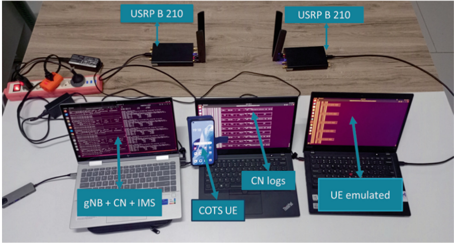
Fig. 2. The experimental 5G SA testbed.
